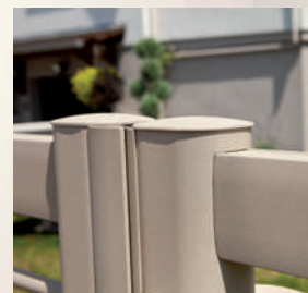
Sections de profils robustes : Montant 113 x 83 mm Traverses : 94 x 50 mm Double battue avec joints
